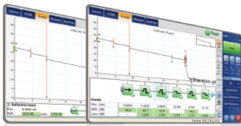
Diese verbesserte Ausführung ermöglicht dem Techniker, flexibel, sowohl die OTDR-Kurve als auch deren lineare Ansicht anzuzeigen, ohne die Messung an der Glasfaser wiederholen zu müssen.
